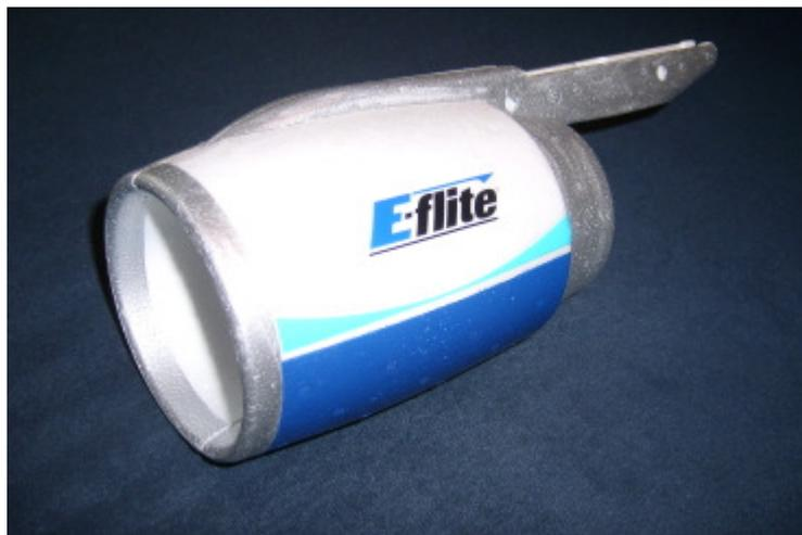
Der Impeller Vasa 65 MK2 aus CFK mit 65mm Durchmesser und der Brushless MEGA 16/15/3 incl. Regler Emax 20A scheinen für die Triebwerksgondel von Eflight geschaffen zu sein. Diese passen ohne Nachbearbeitung in die Schalen.
